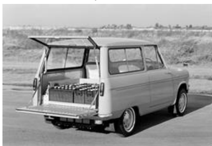
図3 三菱360バン改造電気自動車(1966) (14)
